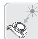
Quando si indossa l'orologio, assicurarsi che il quadrante (pannello solare) non sia coperto dalla luce dalla manica dei vestiti. L'efficienza di generazione dell'energia è ridotta anche quando il quadrante dell'orologio è coperto solo parzialmente.
